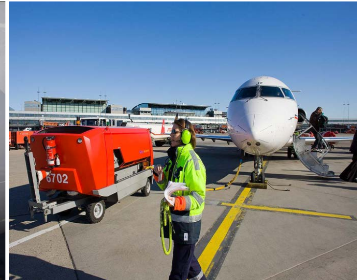
Mobile Dieselaggregate mit Rußpartikelfilter (GPU) und zur Klimatisierung PreConditioned Air (PCA)
